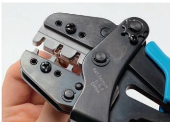
② 圧着の際はダイス端面に絶縁圧着部後端を合せる。
