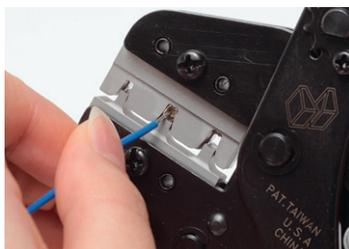
④ 予め被覆を剥いた電線を端子の芯線圧着部に挿入します。
