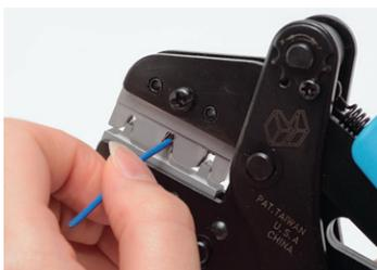
⑤ 被覆が芯線圧着部に当たる手前まで挿入し、電線被覆部をインスレーションパレルに出来るだけ押し。
